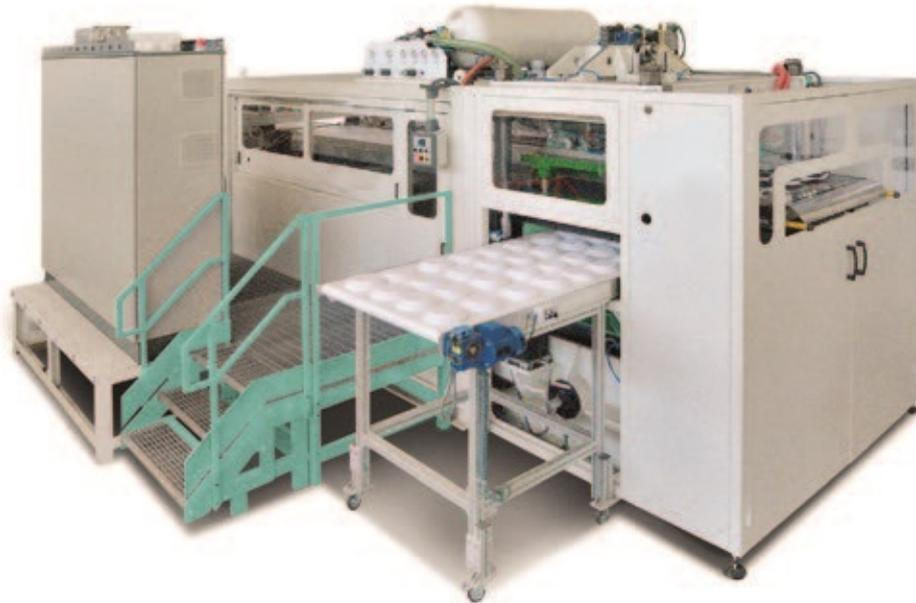
Macchine ad alta produttività per piatti, vassoi e articoli con basse profondità di imbutitura. Formatura e trancia nella stessa stazione e impilamento integrato nella parte inferiore dello stampo. Adatta alla lavorazione di prodotti in HIPS, in quanto la formatura è con solo vuoto.
